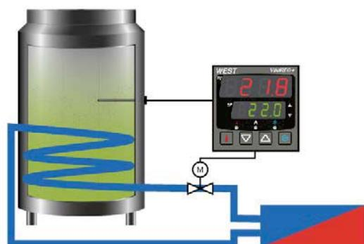
En fonction du mode sélectionné, il est possible de régler la sortie principale du Vinireg+ sur la commande d'eau chaude ou d'eau froide.
