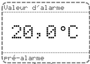
Valeur d'alarme (point de commande) du relais de pré-alarme
