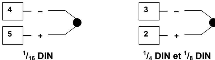
Figure 15. Raccordement entrées thermocouples
