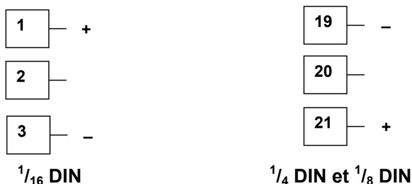
Figure 21. Carte option 1 – Module à tension linéaire et mA CC
