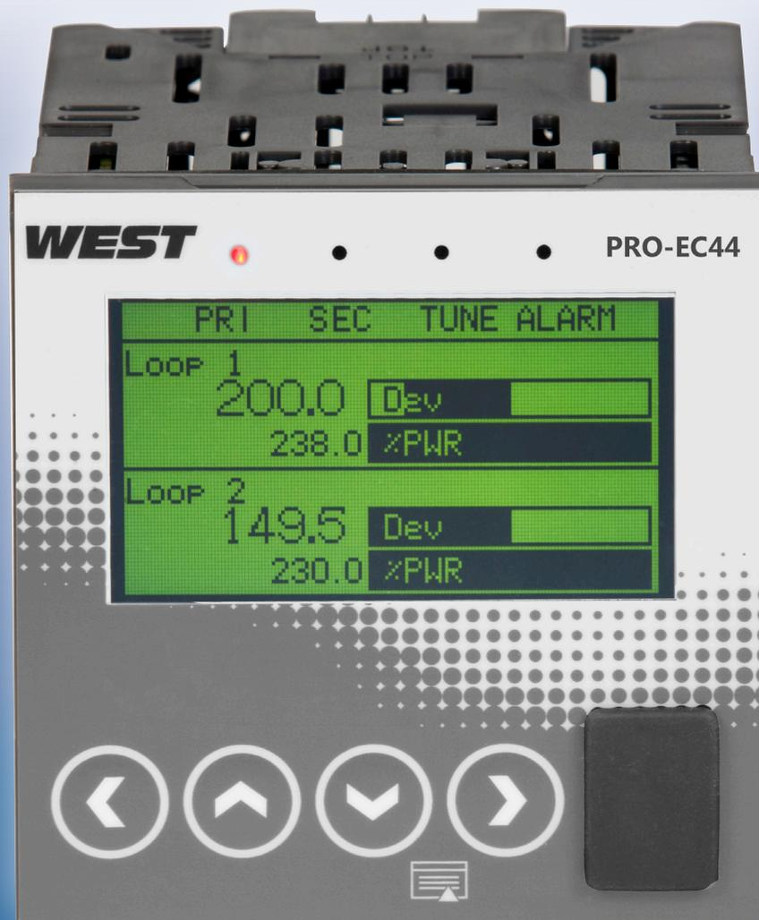
Une utilisation simplifiée : interface intuitive, port USB frontal facile d'accès et un logiciel de configuration et de simulation simple à utiliser, Blue Control®.
