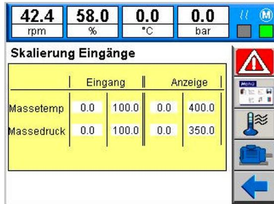
Mit Hilfe der Skalierung können die analogen Eingänge für Massedruck und Massetemperatur eingestellt werden.
