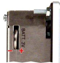
Abb. 41: Batteriefach
