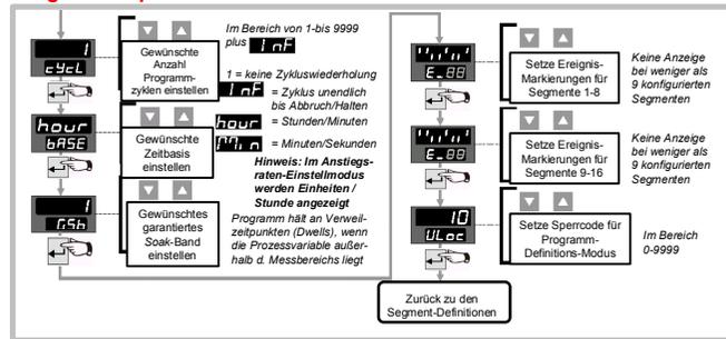
Segment Ereignis-Status. Jedem Segment ist eine Ereigniskennung zugeordnet, die nach Wunsch EIN- oder AUSgeschaltet werden kann.
