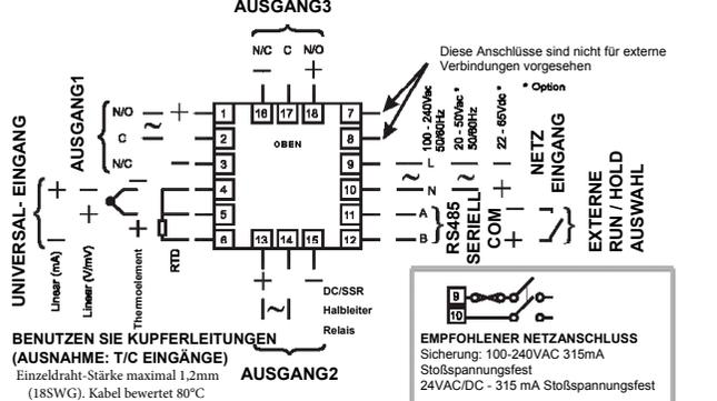
**AUSGANG 1:** Immer primäres Regler- (HEIZEN) Ausgangsrelais, SSR-Modul, Halbleiter oder DC.
