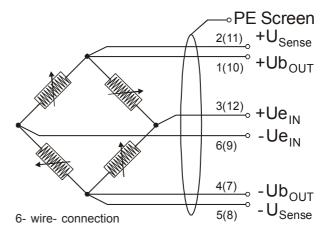
4- wire- connection: connect  $\mathsf{Ub}_\mathsf{OUT}$  and  $\mathsf{U}_\mathsf{Sense}$  at the  $\mathsf{Ub}$ -terminal of the sensor.
